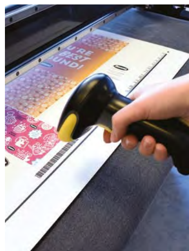
Przebieg pracy z kodami kreskowymi przy użyciu ręcznego skanera
